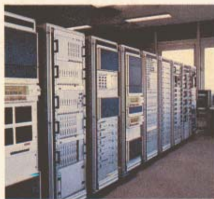
Les quatre ordinateurs Nova 3 de Data General traitent les données télétransmises du terrain et régulent le trafic.
