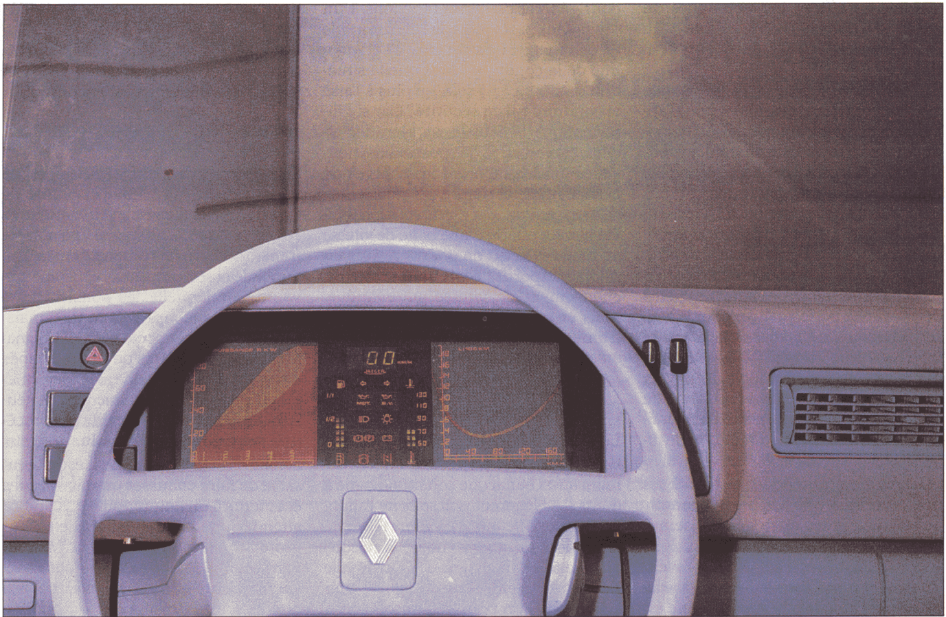
« On sait le faire », Renault donne peu d'informations sur ses recherches. Ce document exceptionnel constitue la preuve que la firme française maîtrise la technologie des écrans couleurs à cristaux liquides (ici dans une cabine de simulateur).
