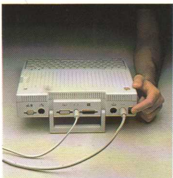
Figure 1-8. Mise sous tension
